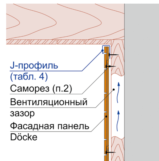
Рис. 25 Примыкание фасадных панелей Döcke к горизонтальной поверхности
